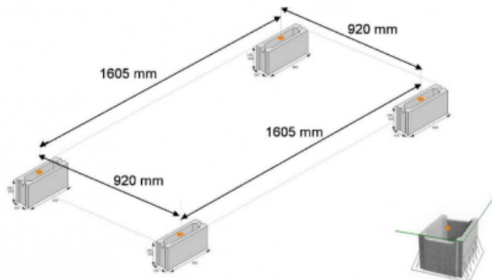
Kromě vnitřku tvárnice doporučujeme obetonovat i její venkovní stranu do poloviny výšky tvárnice.
